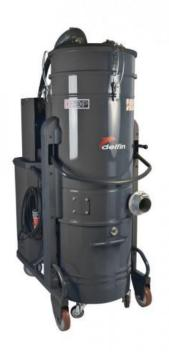
Пылесосы оборудованы картриджами-фильтрами с большой площадью фильтрующей поверхности (2 антистатических, фильтрация класса М). Фильтры автоматически очищаются воздушными потоками. Чистка фильтров с помощью обратного импульса является наиболее эффективным методом при всасывании мелкой, сухой или засоряющей пыли, особенно при постоянной нагрузке или при собирании больших объемов пыли.
